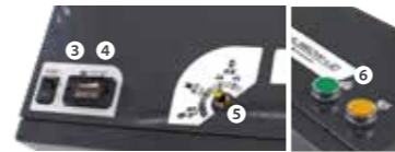
③電源スイッチ ④バッテリー残量 ⑤ロータリースイッチ(前進低速・前進高速・走行OFF・後進低速) ⑥上昇ボタン・下降ボタン
